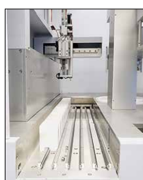
親検体容器ラック収容口
