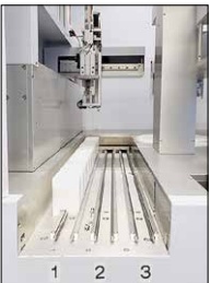
親検体容器ラック収容口
