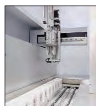
親検体搬送用ロボットアーム
