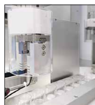
子検体開栓ロボットヘッド
