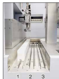
親検体容器ラック収容口
