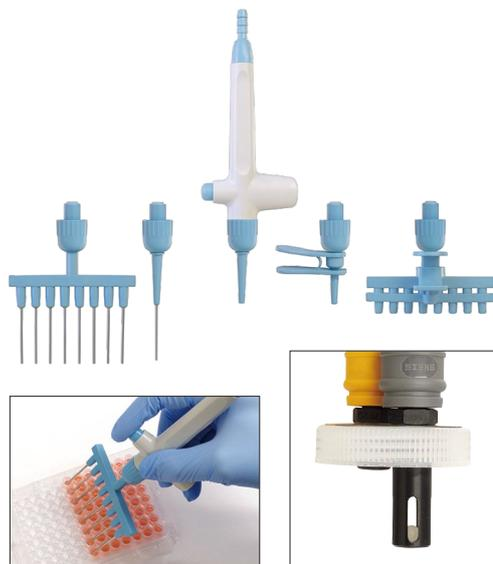
ハンドオペレーターその他、ステンレスニードルノズルやマイクロピペットのチップが使用できるアダプターが付属します。
