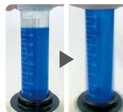
50mL デイスボ遠沈管なら、40mL まで液量があっても確実に攪拌できます。震動を効果的に伝えるために、同容器のキャップ部分をしっかりと持つのがお勧めです。
