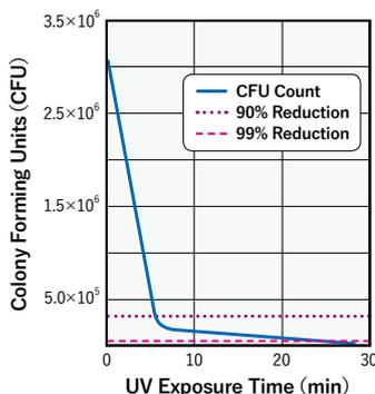
*S. aureus*の培養液で下部表面を汚染したマイクロピペットをNichimate UV CarouselによりUVに曝した。UV照射の途中でマイクロピペットを取り出してゆき、各マイクロピペットの汚染部分をリンスして回収した液をプレーティングして生じたコロニーを数えた。結果、28分のUV照射で99%のコロニー数減少が見られた(当実験は外部機関により実施された)。
